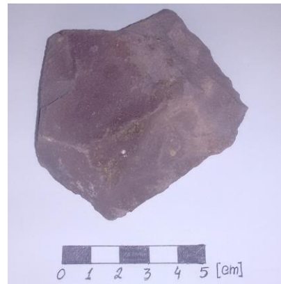
Figura 28 - Rocha utilizada nas paredes da Fortaleza de Cambambe. Amostra disponibilizada pelo Prof. Rui Vaz Rodrigues.
