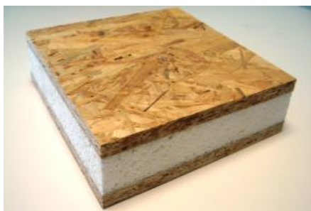
Figura 42 - Amostra de painel sandwich com uma camada de isolamento térmico e duas camadas de OSB [40].
